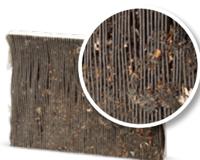
Sans maintenance du système de climatisation
