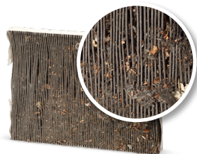
Sans maintenance du système de climatisation
