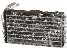
Sans maintenance du système de climatisation
